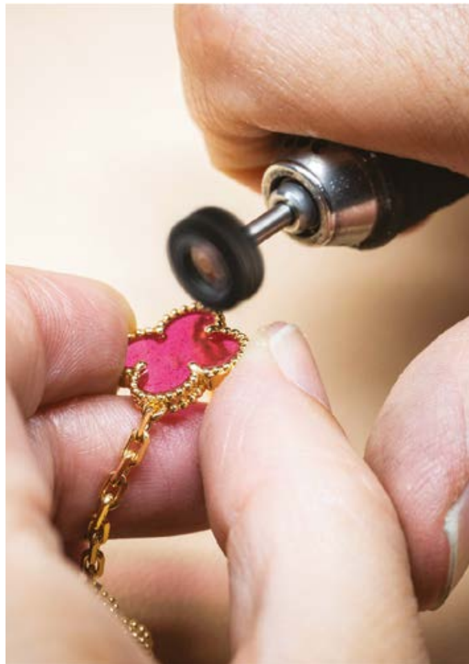
Laatste polijsting van de Vintage Alhambra-hanger met een polijststift
