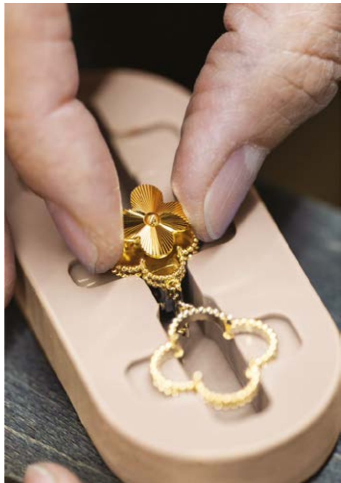
Werk aan de griffen van het guilloché Alhambra-motief
