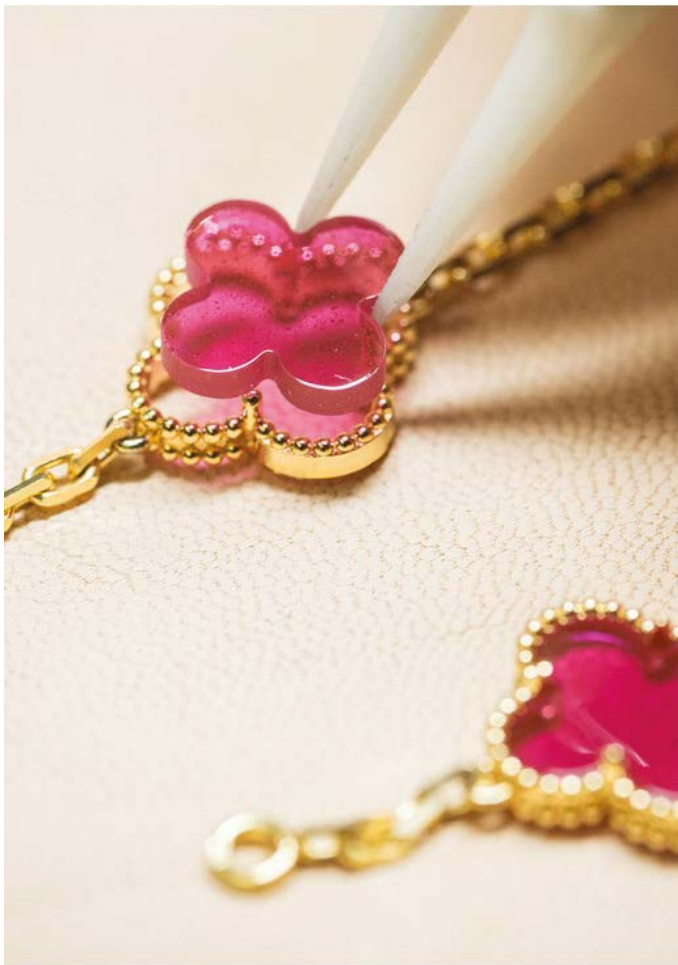
Het plaatsen van een roze emaillemotief in de geelgouden zetting
